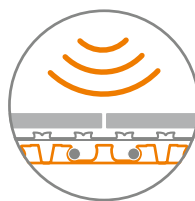
Aislamiento acústico a ruido de impacto
